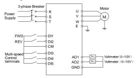
Fig9-3 Basic wiring
